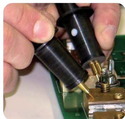
上图所示为使用BCP-10 探针测试分流器和电路板之间路径的接触电阻
