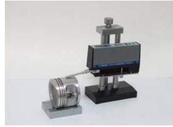
— 大多数的表面粗糙度测量使用 SFP-2001 型，国际标准的圆锥形金刚石触针， $R = .0004''/10\mu\text{m}$ ；SFP-2002 型， $R = .0002''/5\mu\text{m}$ 。用于检测平面、外圆，直径不小于 60 的内孔，以及曲轴等。
