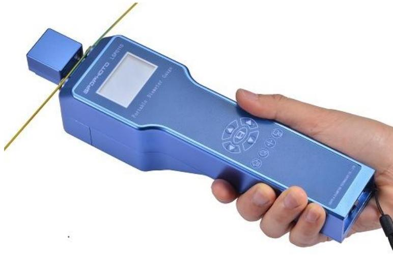
6.2) LSP-0110 B 型测量方式 (加长舌头, 导轮平放, 后拉过线)
